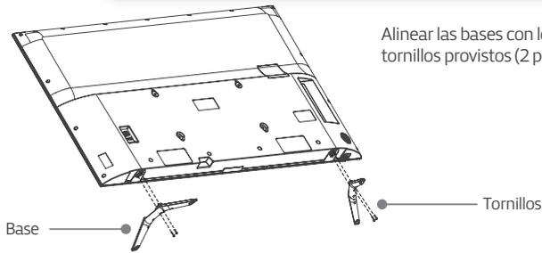
Alinear las bases con los agujeros y fijar con los 4 tornillos provistos (2 por cada pie)
